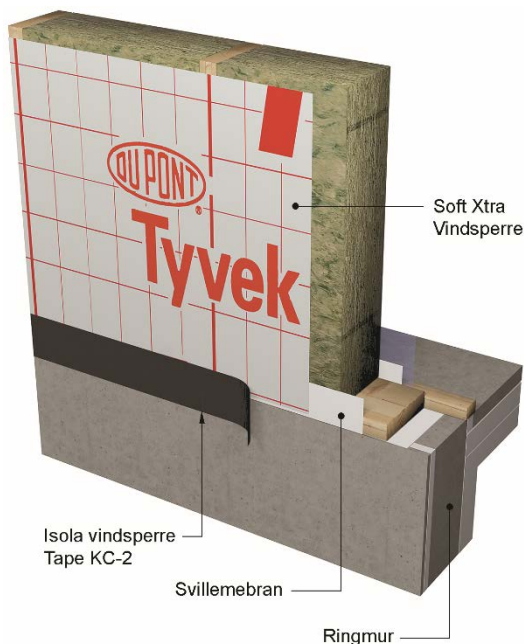
Fig. 5 Eksempel på bruk av Isola KC-2 Vindsperre Tape 50/85 til forsegling av overgang mellom ringmur av betong og Isola Soft Xtra Vindsperre på yttervegg. Det festes tape med 85 mm bredde til betongen og 50 mm til vindsperre på veggen. Figur: Isola as
