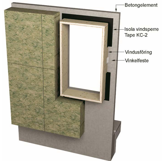
Fig. 6 Eksempel på bruk av Isola KC-2 Vindsperre Tape 50/85 på utvendig vindusføring i betongelementer med utenpåliggende isolasjon. Det festes tape med 85 mm bredde til betongen og 50 mm til vindusrammen. KC Tapen monteres etter at rammen er satt på plass slik at tapen vil dekke over vinklene som fester rammen til veggen. Figur: Isola as
