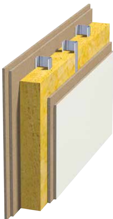
Fig. 6 Innvendig vegg. Forskjøvet stålstender med to platelag
