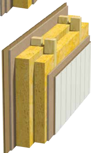
Fig. 4 Innvendig vegg. Dobbel heltre stender. To platelag.
